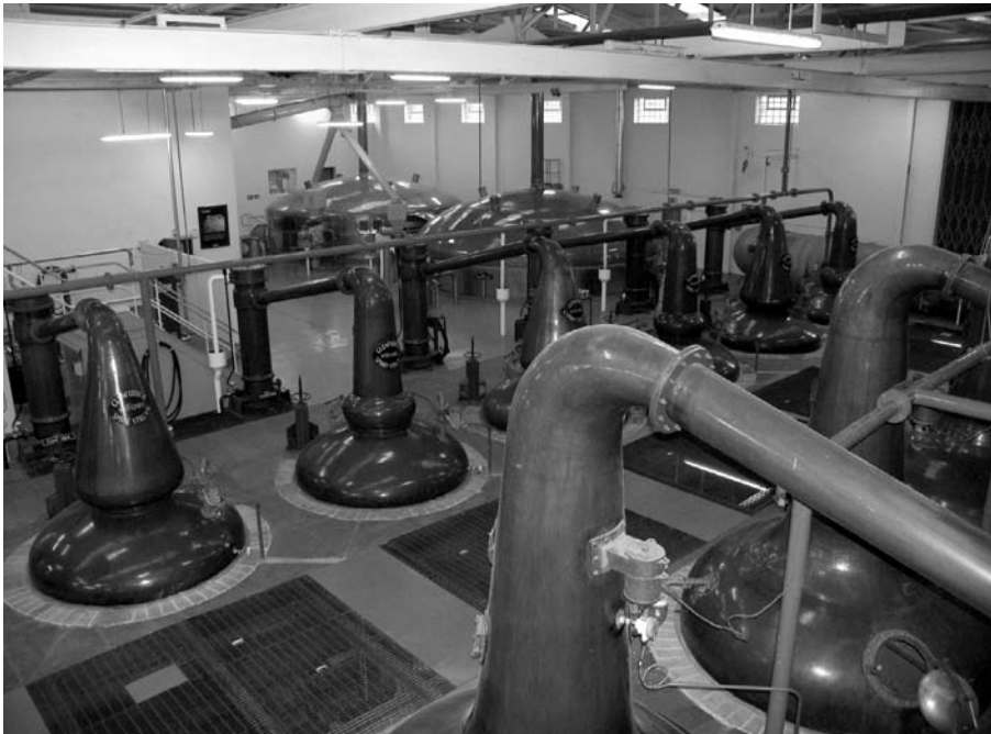
Kuva 4. Glenfiddich-tislaamon kupparipannut käyvät kuumana. Vaikka teollinen prosessi on tarkasti ohjattu ja hyvin tunnettu, viskin valmistamiseen liitetään yhä salatieteen piirteitä.
