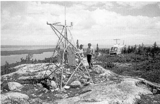
Kuva 8. Säähavaintoasema, jonka hurisevan tuulimittarin utelias karhu on toistuvasti kiivennyt noutamaan. Tämä automaattinen asema kuuluu Lavalin yliopiston Centre d'Études Nordiques'n laajaan meteorologiseen tiedonkeruuverkostoon. (Kuva kirjoittajan 07/98)
