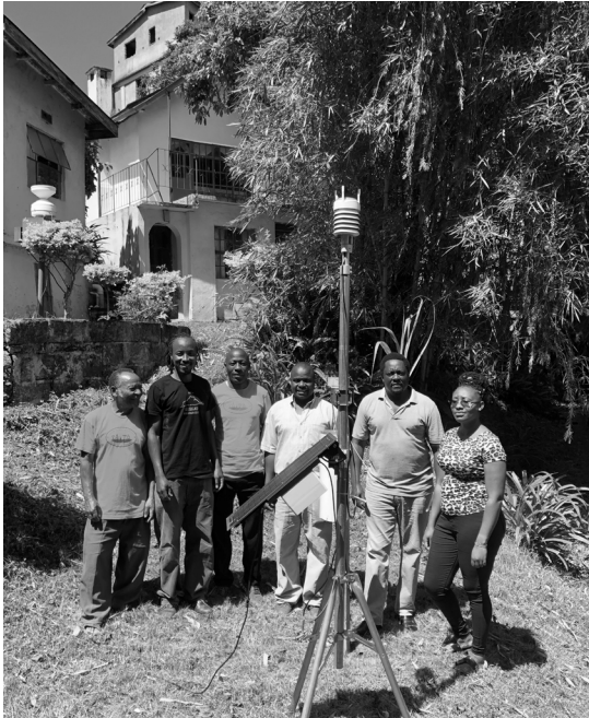
Taitan tutkimusasemalla otettiin joulukuussa käyttöön uusi säätilaa ja ilmanlaatua mittaava Vaisalan laite, jota aseman henkilökunta pitää toiminnassa maastossa sijaitsevan mittausverkoston lisäksi. Kuva: Petri Pellikka.
